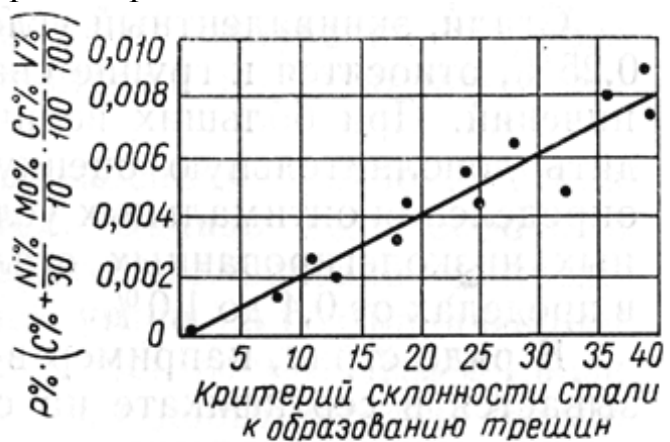
Рис. 1.9. Совместное влияние элементов P, C, Ni, Mo, Cr, V на склонность высокопрочных сталей к образованию горячих трещин.
